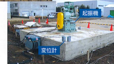
実大実験 (起振機試験)
